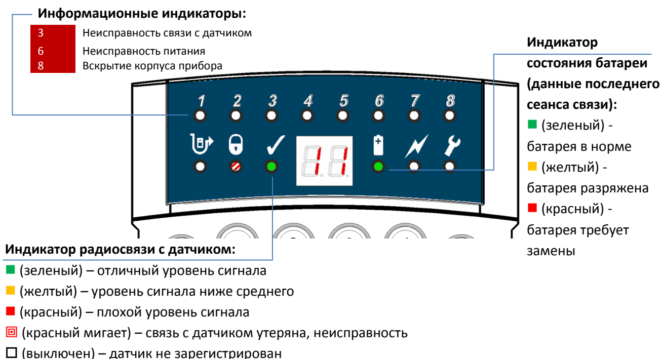
Рис. 32. Состояние датчика в нарушенной зоне
