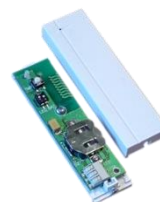
Рис. 4. KC131PC Магнитоcontact и устройство управления светодиодом и СМК
