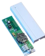
Рис. 12. КС131РС (Новый) Магнитоcontact и устройство управления светодиодом и СМК
