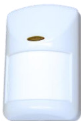
Рис. 5. KC101P. Беспроводный датчик движения
